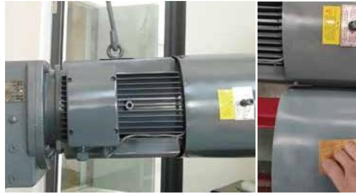
改进型刹车系统, 更方便手动释放, 螺丝拧紧制动器即打开
